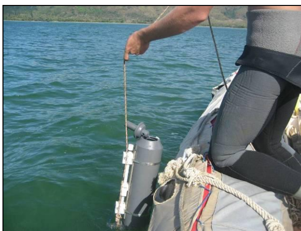
Figure 2 : Echantillonneur 5 litres pour les prélèvements d'eau
