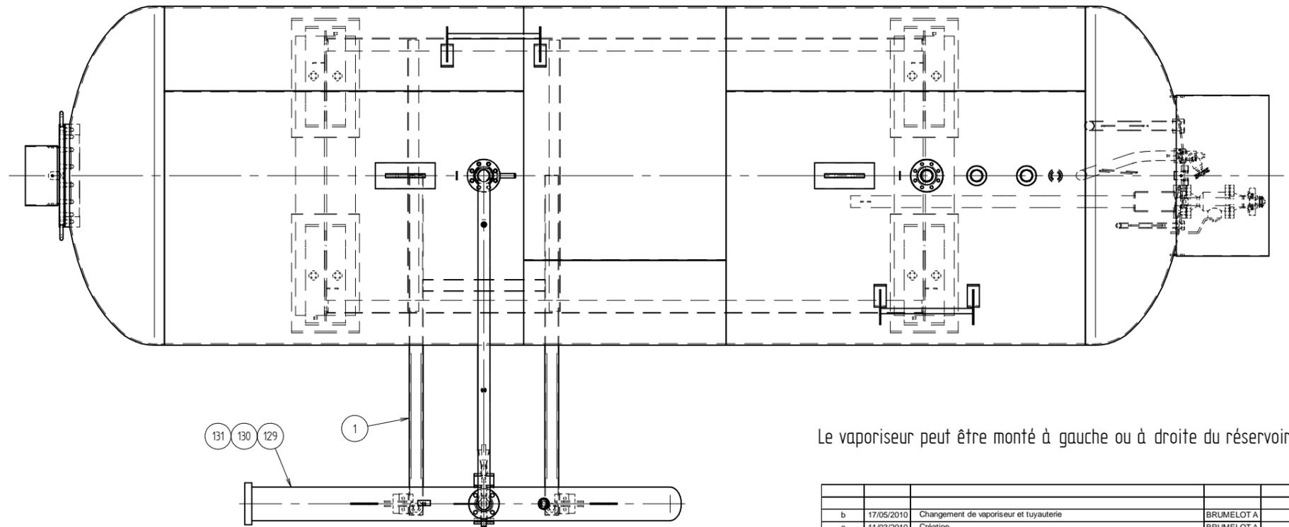
Le vaporiseur peut être monté à gauche ou à droite du réservoir
