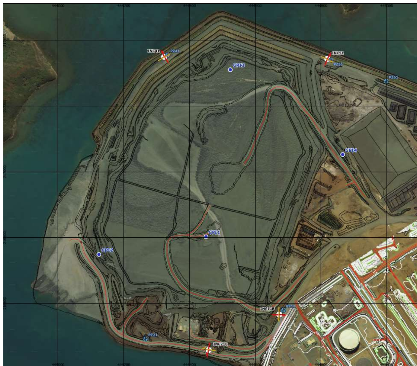
Figure N° 7 : Implantation du dispositif d'instrumentation de la verse à scories
