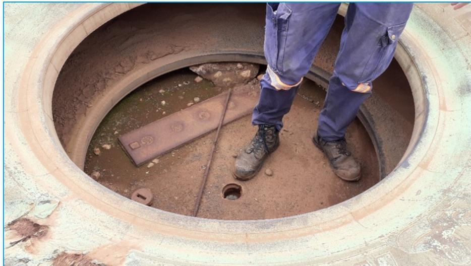
Figure 6 : Piézomètre P5. L'ouvrage est situé à ras du sol et est protégé par un pneu - Source : EMR, 2020.
