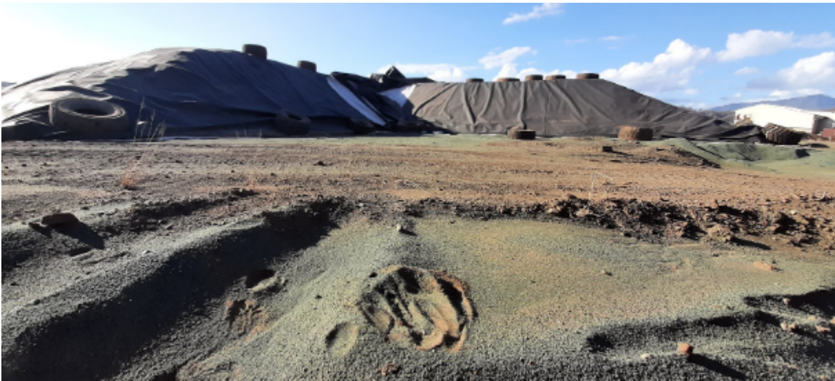
Photo 2 : Prise d'échantillon – Echantillon « témoin » à 30m de la zone avec géomembrane dégradée - jonction entre les alvéoles n°28 et n°29
