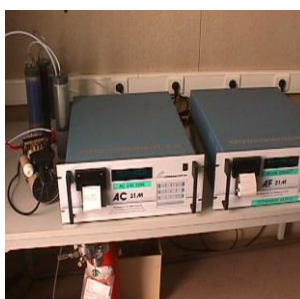
Figure 2 : Analyseurs SO 2 et NO 2 et analyseur de poussières
