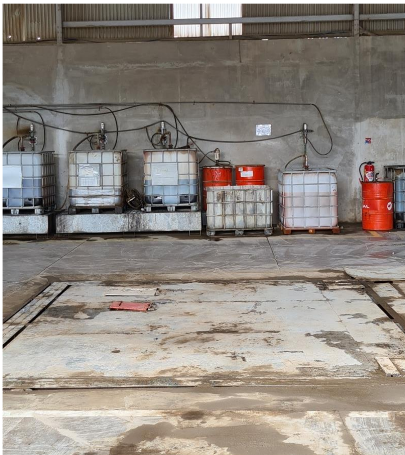
Figure 6 : Vue de l'atelier de réparation et d'entretien des véhicules et engins à moteur avec sa cuve de vidange
