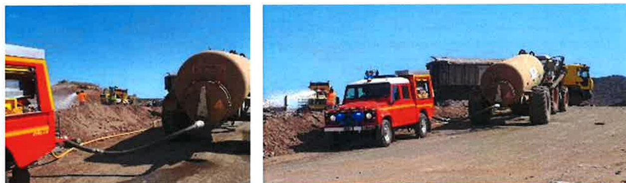
Figure 17 : Véhicule de Première Intervention (VPI) alimenté par la tonne à eau et le tracteur
