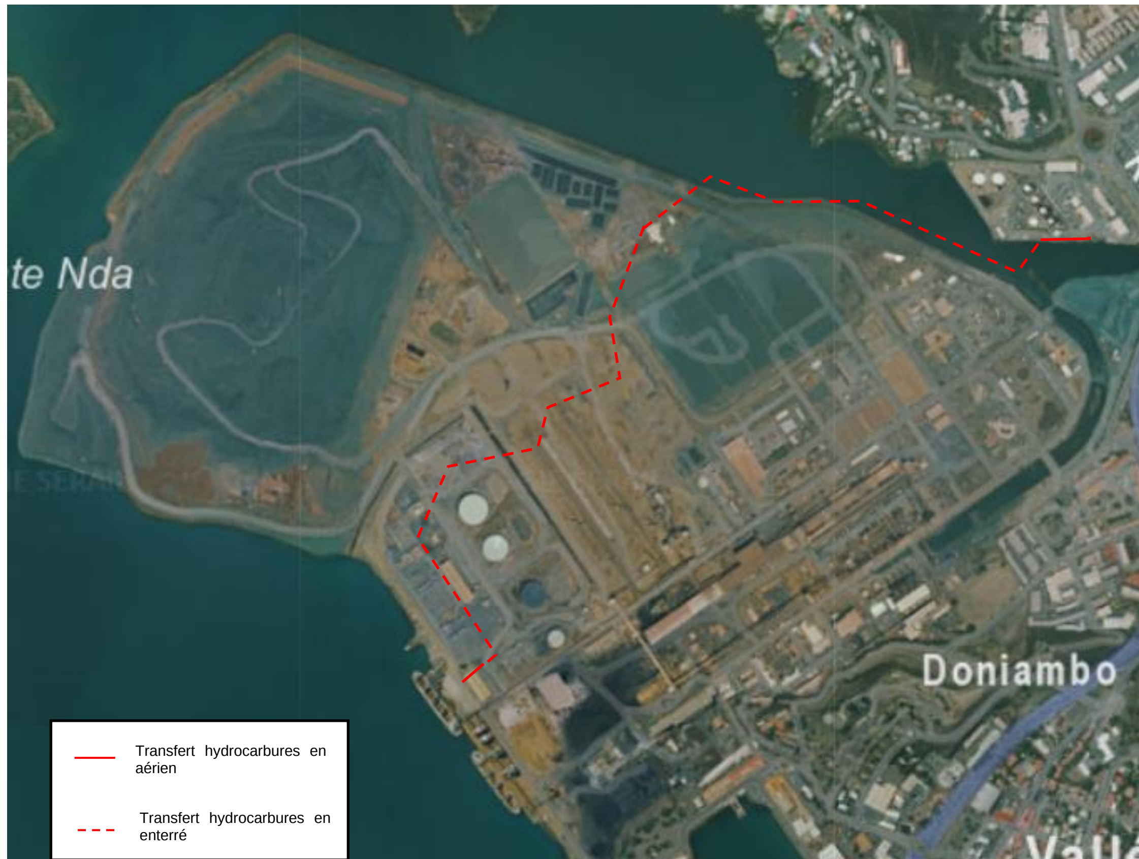
Figure 8 : Potentiels de dangers liés à la canalisation de dépotage hydrocarbures
