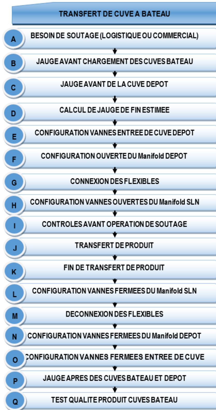
Figure 51 : Procédure de soutage
