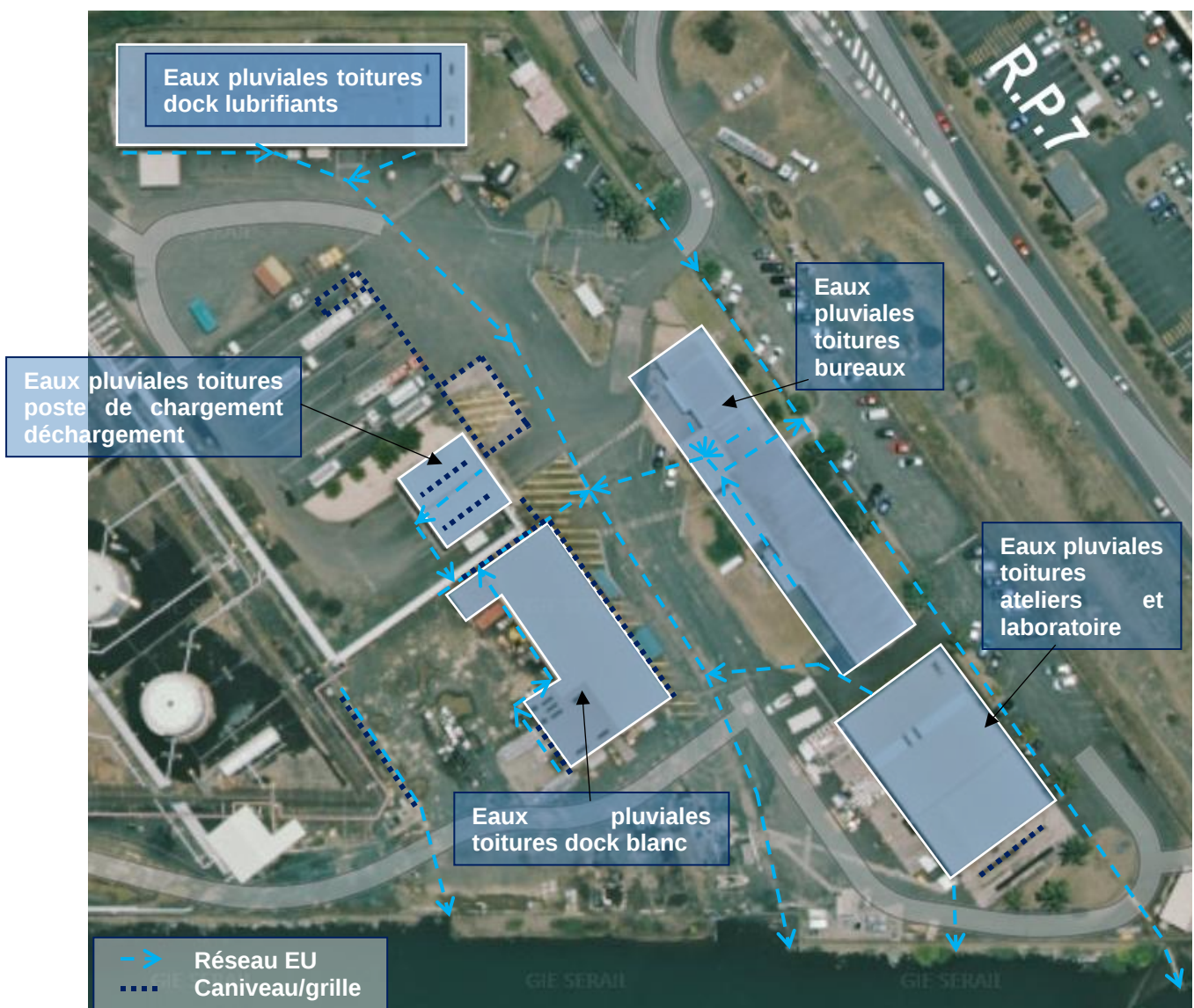
Figure 44 : Plan du réseau d'eau pluviale
