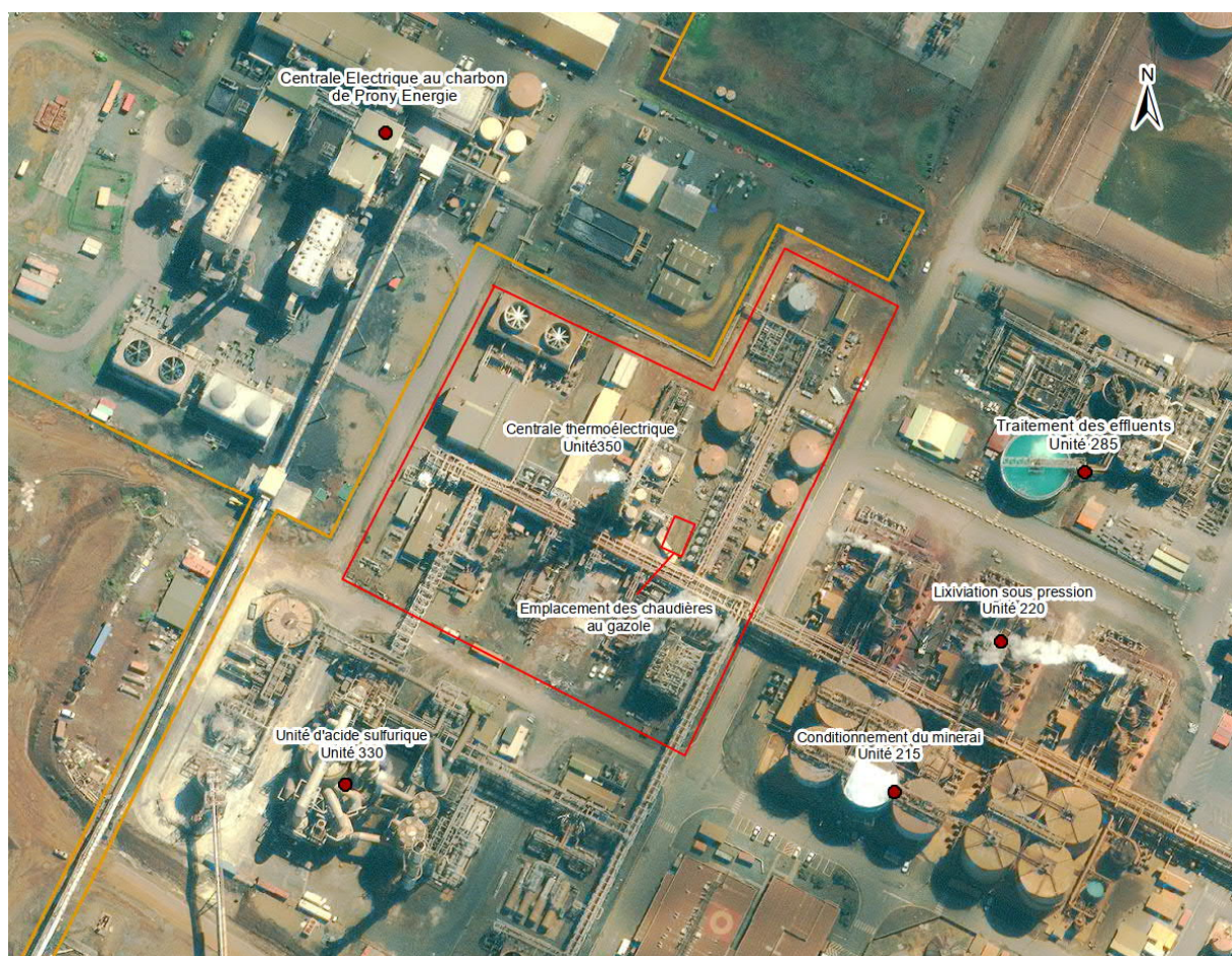
Figure 1 : Localisation des nouvelles chaudières dans l'unité 350
