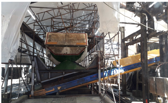
Figure 19 : Photo/schéma du déchargement du NHC dans la trémie
