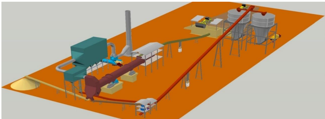
Figure 12. Exemple de d'usine d'assèchement utilisant un four rotatif
