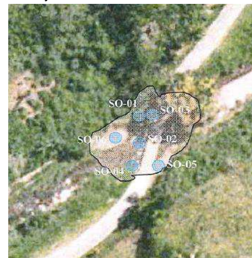
Figure 8 : implantation des stations d'observation et cartographie de l'aléa risque amiante (LBTP, 2015)
