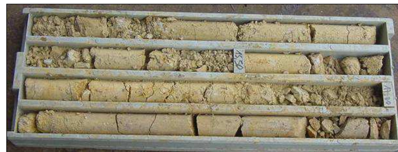
Sondage carotté SC1 de -14.00 à -18.00 m de profondeur
