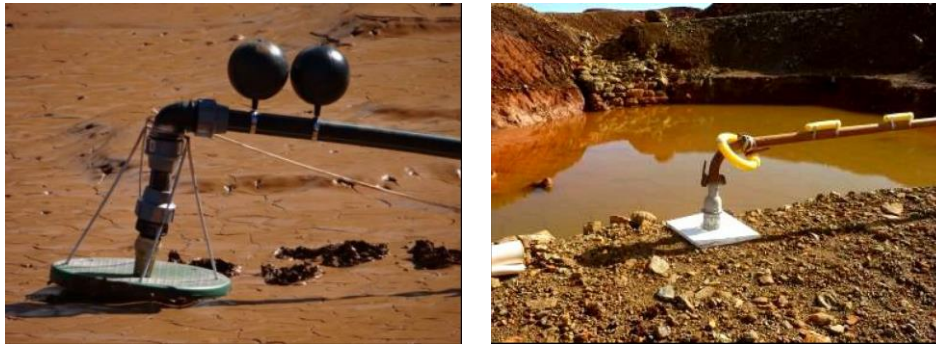
Figure 18 : Illustration de systèmes de vidange volontaire selon le modèle DIVIDEC de MC environnement
