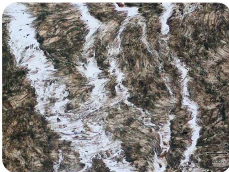
Veine à chrysotile au microscope optique (Pora) Source : Atlas CNRT 2012
