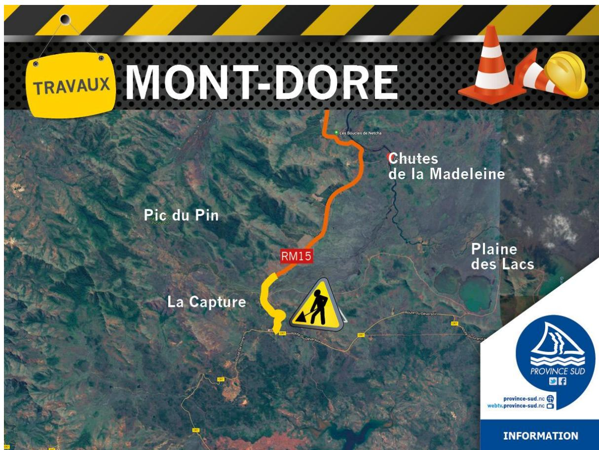
La RM15 (route municipale n°15) assure la desserte de l'usine du Sud. L'augmentation du trafic poids lourds, liée à la construction de l'usine et à son exploitation, a engendré un vieillissement prématûr de la structure de chaussée. Les travaux, d'une durée d'un mois, consistent donc à renforcer la chaussée existante et à réaliser un nouveau revêtement.
