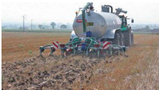
Figure 24 : Épandage lisier avec enfouissement et épandeur à fumier avec table.
