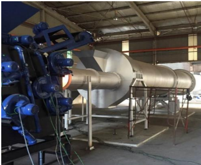
Figure 36 : Sécheur direct avec gazéificateur biomasse
