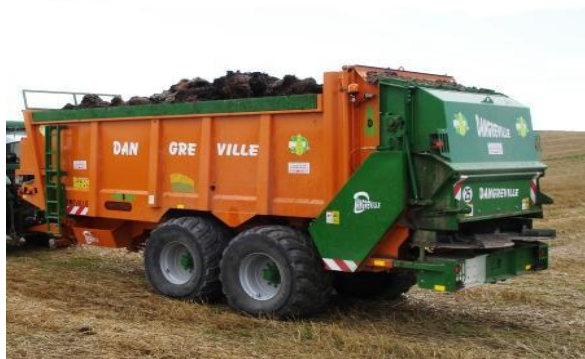
Figure 24 : Épandage lisier avec enfouissement et épandeur à fumier avec table.
