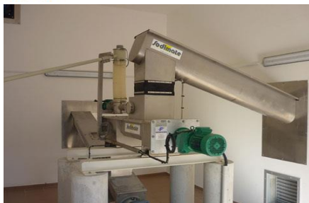
Figure 32 : Mélangeur boues/chaux (Sodimate)
