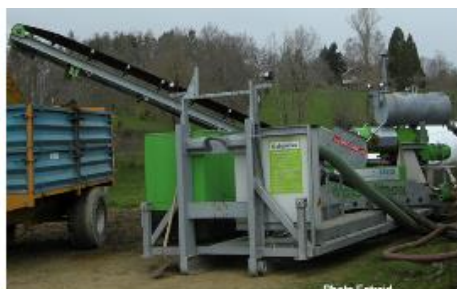
Figure 26 : Photo tamis statique, vis compacteuse mobile et centrifugeuse
