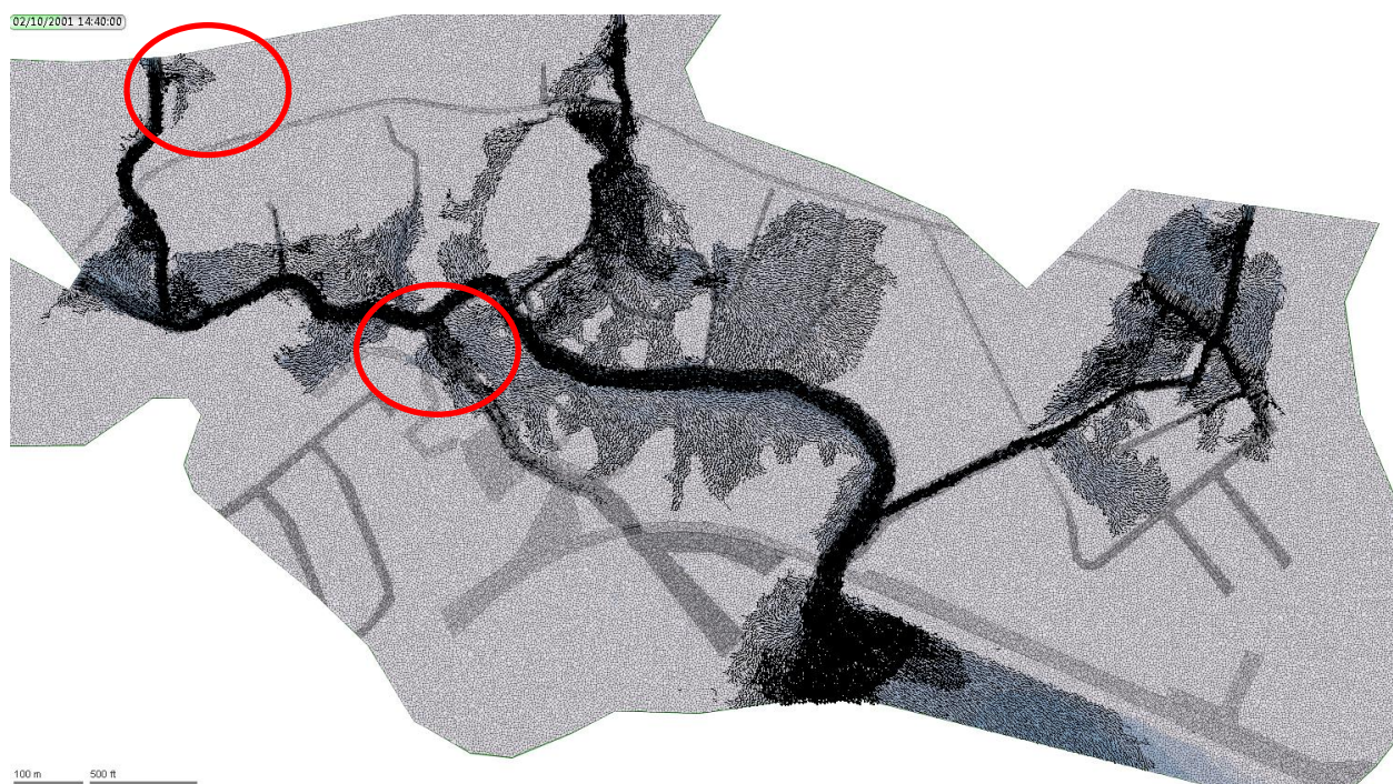
Figure 36 : crue 2001, début de débordement en amont de la RP1 et mise en fonctionnement du canal de décharge
