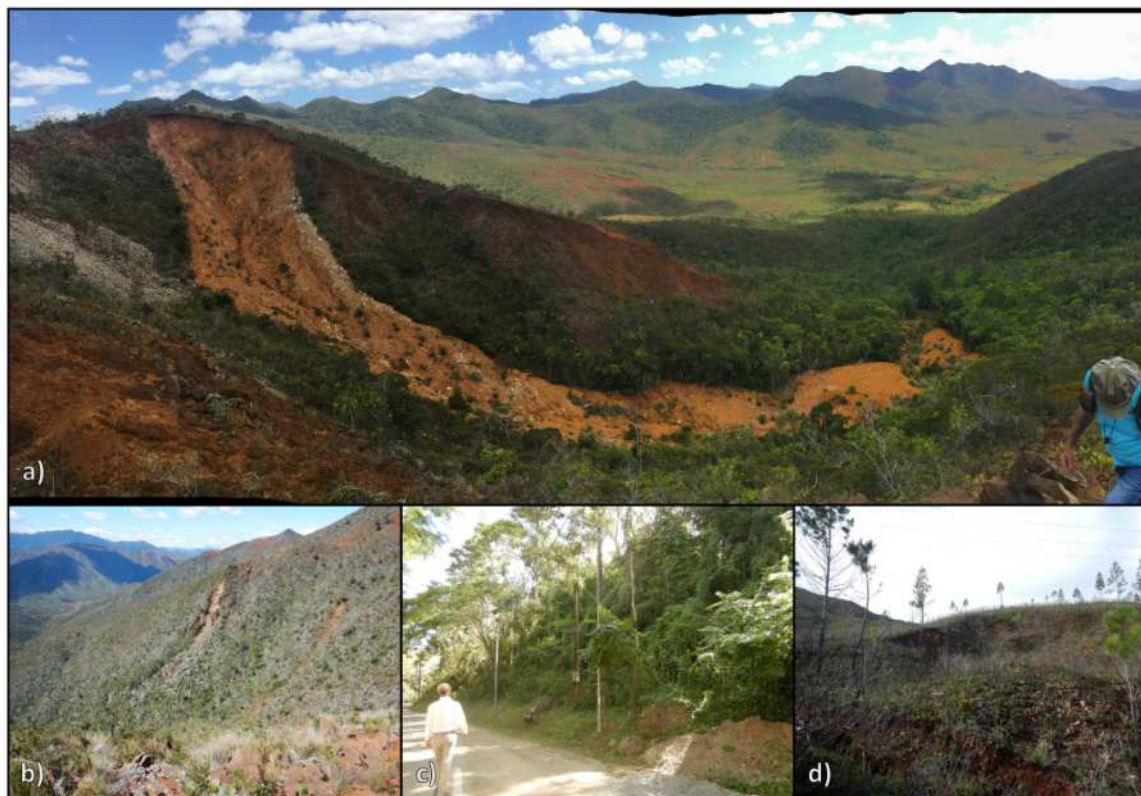
illustration 18 – Différents types de phénomènes rencontrés sur la commune : a) Lave torrentielle, Col des deux tétons ; b) Glissement grossier, Vallée de la Coulée ; c) Chute de blocs, Yahoué ; Glissement fin, La Coulée.
