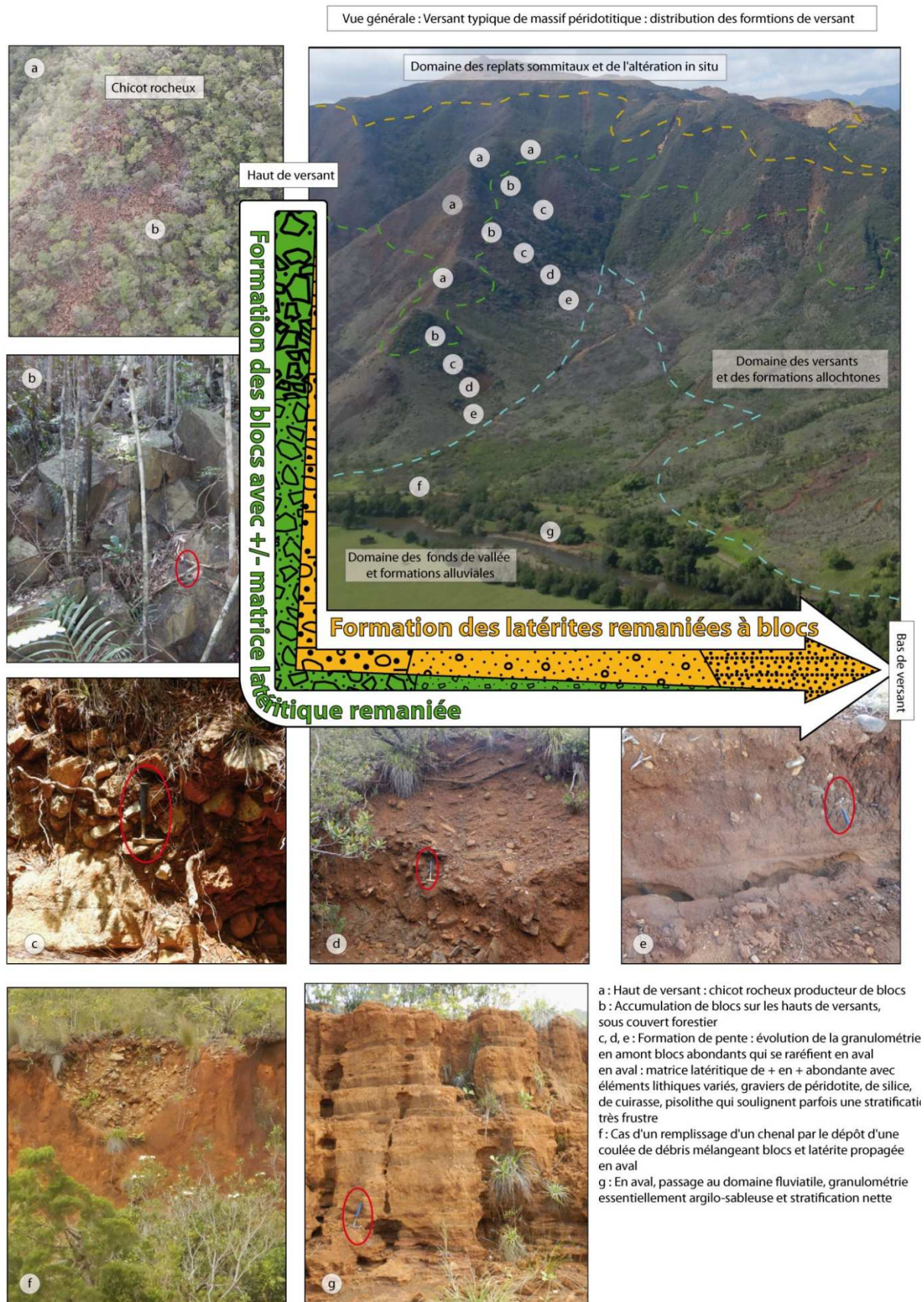
illustration 15 – Schéma des faciès rencontrés sur versant de massif de péridotites
