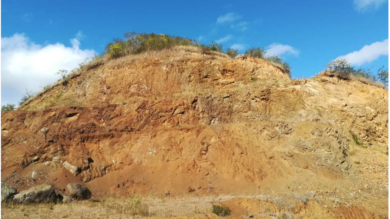
illustration 12 – Talus de carrière dans les basaltes avec altération typique couleur chocolat au lait
