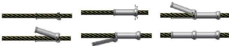
Figure 7 : Procédure d'installation des coques de protection sur le câble
