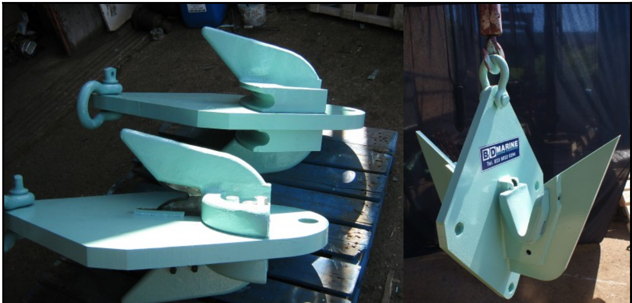
Figure 14 : Grappins pour la réparation pour couper le câble (gauche) et pour le remonter (droite)
