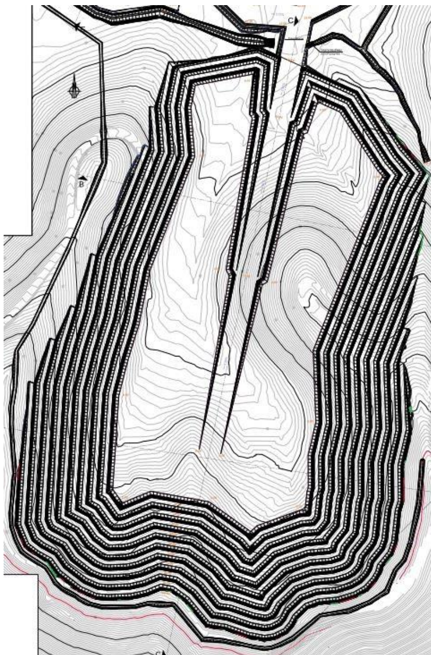
Figure 12 : Plan prévisionnel de la zone d'extraction jusqu'à la côte 0m NGNC.
