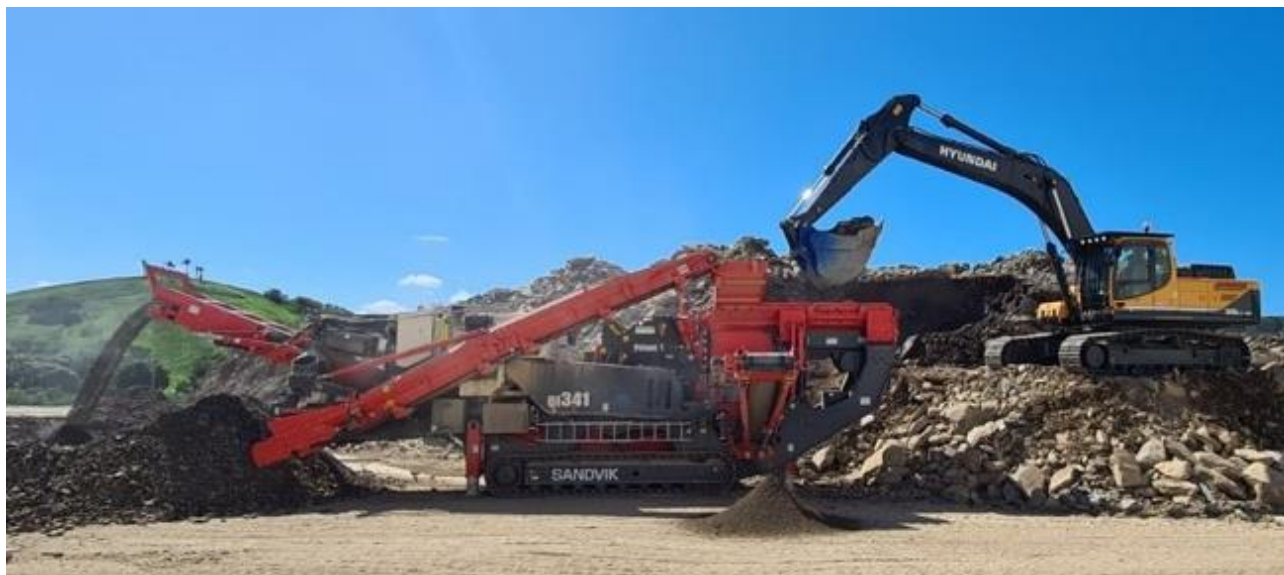
Figure 23 : concasseur mobile à percussion Sandvik QI341 HS
