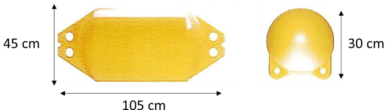
Figure 6 : Flotteurs utilisés pour maintenir la barrière. Gauche : flotteur le long de la barrière, Droite : Flotteurs aux atterrages
