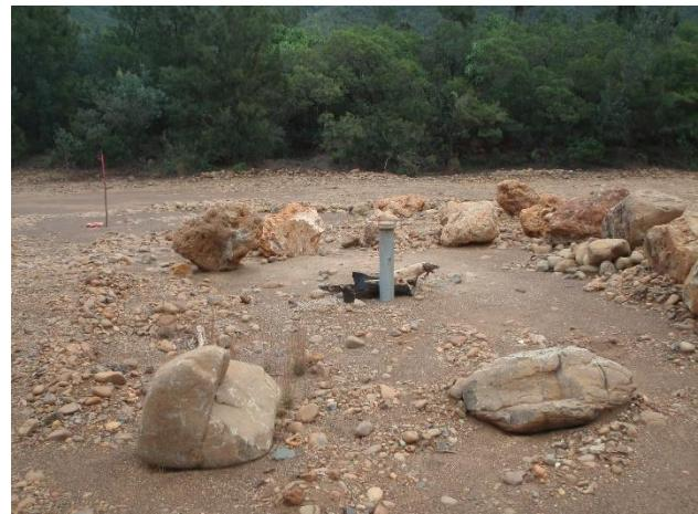
**Piézomètres P3 (à gauche) et P4 (à droite)**
