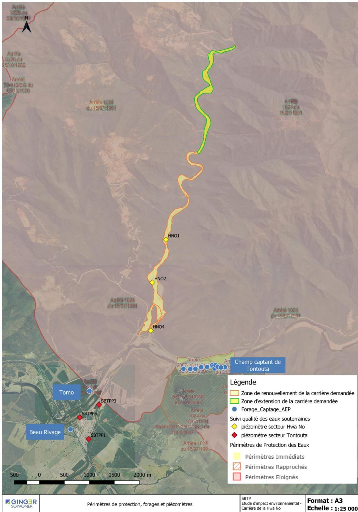
Figure 39 : Forages d'eau potable et périmètres de protection associés
