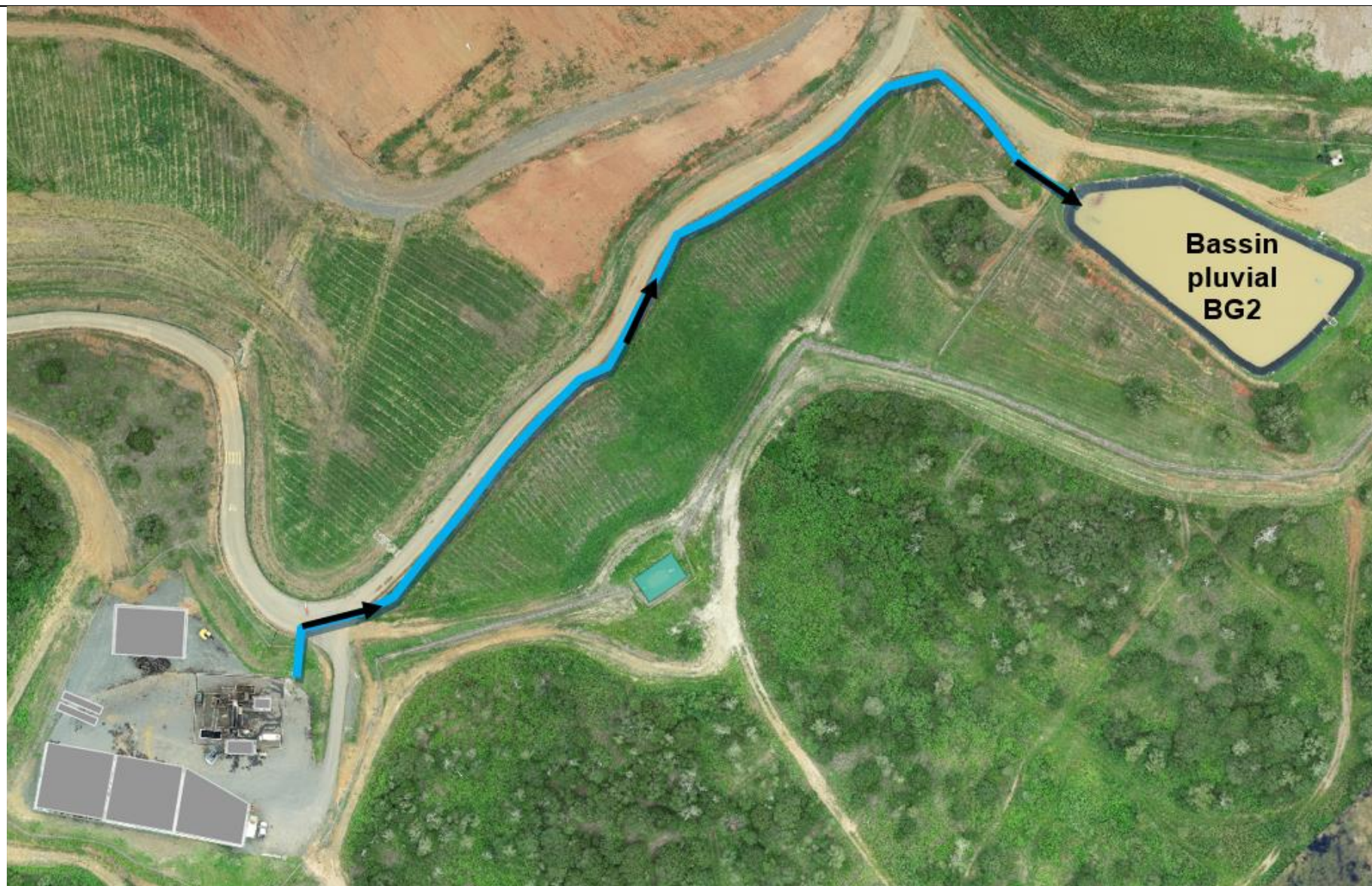
Figure 13 : Cheminement hydraulique des eaux pluviales sortant de la plateforme
