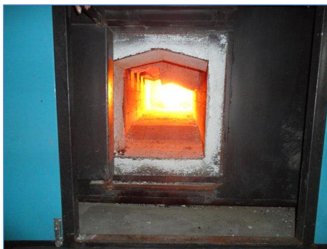
Figure 11 : Chambre secondaire : récupération des cendres
