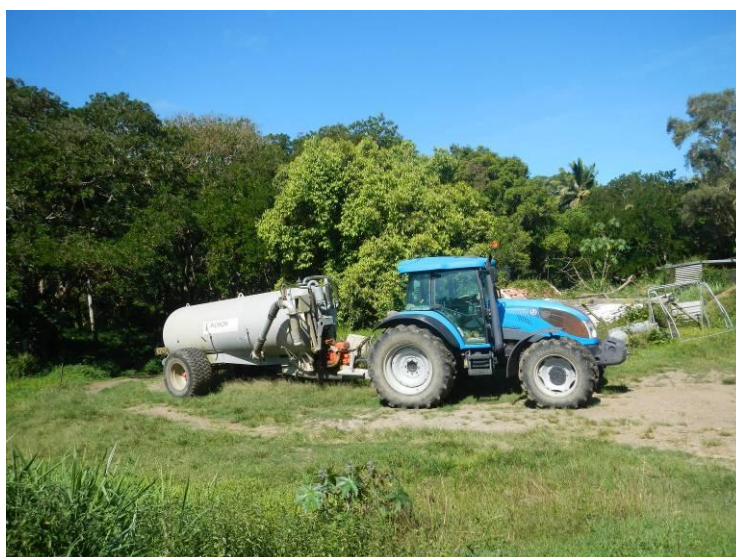
Figure 19 : Equipement utilisé pour pomper les rejets stockés dans les fosses puis épandre sur des terres agricoles
