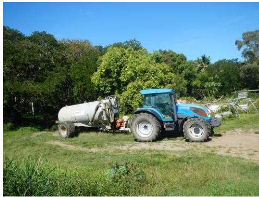
Figure 54 : Equipement utilisé pour pomper les rejets stockés dans les fosses puis épandre sur des terres agricoles
