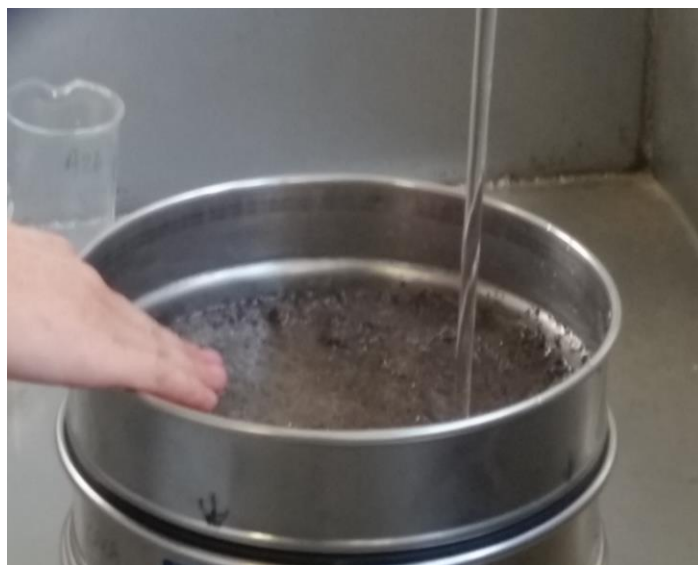
Photographie 6: passage au tamis de 38µm d'un échantillon de sol pour extraire les nématodes
