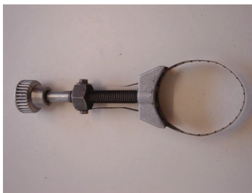
Clé de dévissage à ruban.
