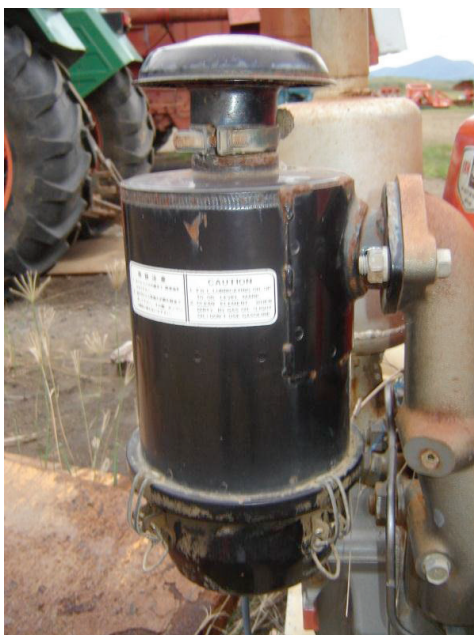
Ci contre: filtre à air à bain d'huile complet.
