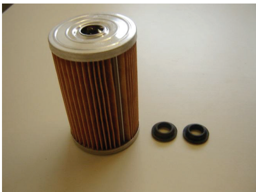
Cartouche filtrante interne avec ses joints
