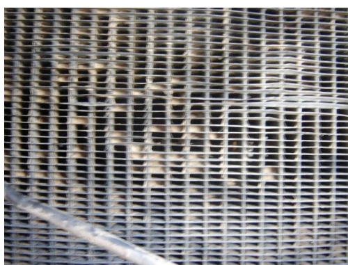
Exemple de radiateur mal entretenu.
