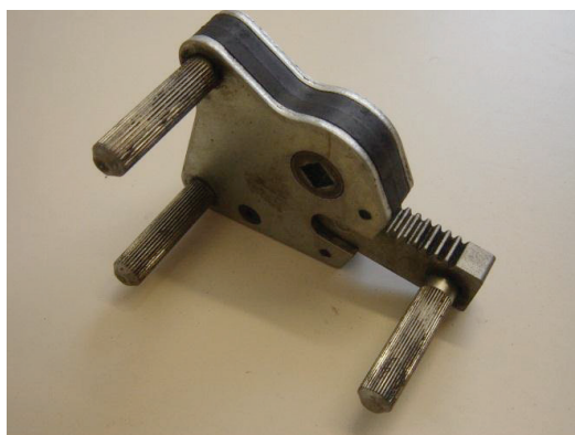
Clé de dévissage à mors auto serrant.
