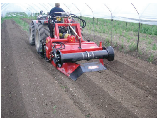
Confection d'un billon trapézoïdale.
