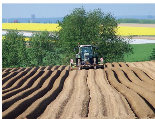
Utilisation de pneus étroits pour éviter un écrasement latéral des buttes.
