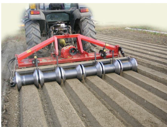
Profilage en butte à l'aide de rouleaux.
