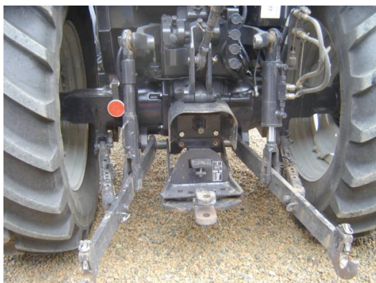
Chandelle droite hydraulique.
