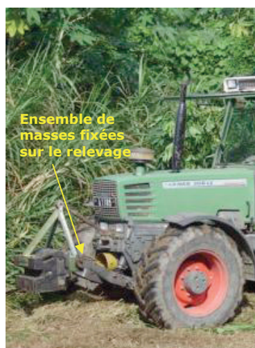
Lestage à l'aide du relevage avant.
