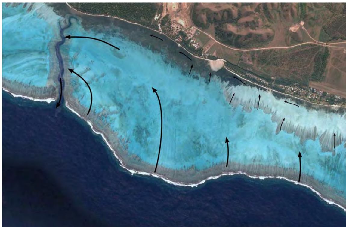
Figure 38 : Schéma de la circulation induite par le forçage tidal
