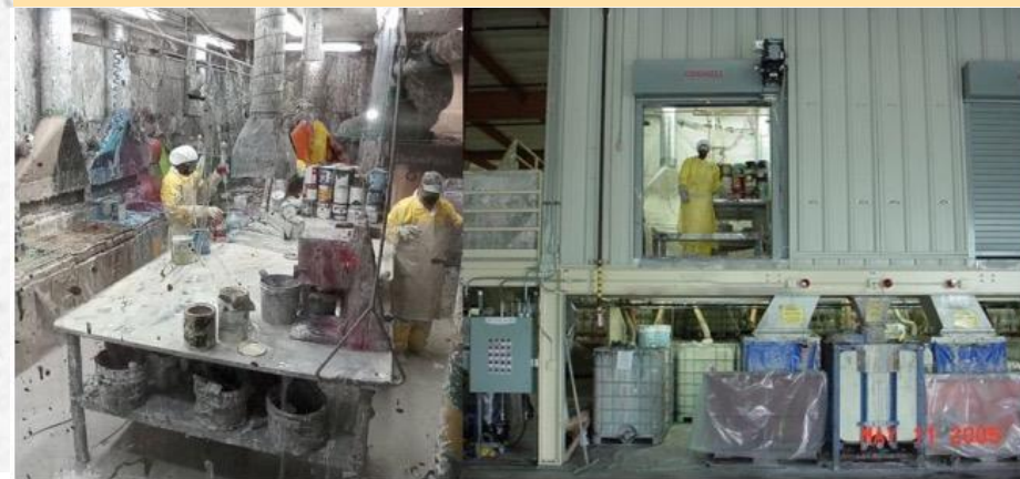
Figure 13 : Photographies de certaines étapes de recyclage À gauche : contrôle et ouverture des pots ; à droite mise en batch (source : MetroPaint)
