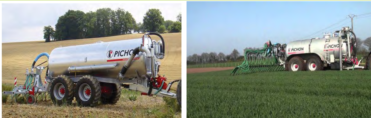
Figure 15 : Exemple de tonne d'épandage équipée d'un enfouisseur ou d'un pendillard (Photos Pichon)
