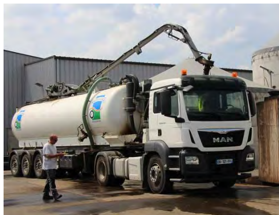
Figure 14 : Exemple de camion de collecte et transport du lisier
