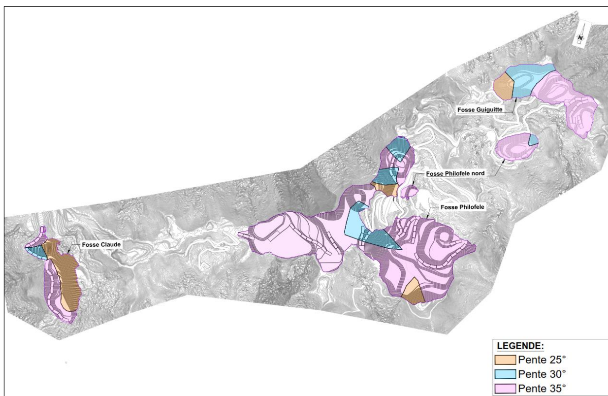
Figure 26 : Carte de zonage relative aux pentes à adopter pour l'exploitation des fosses
