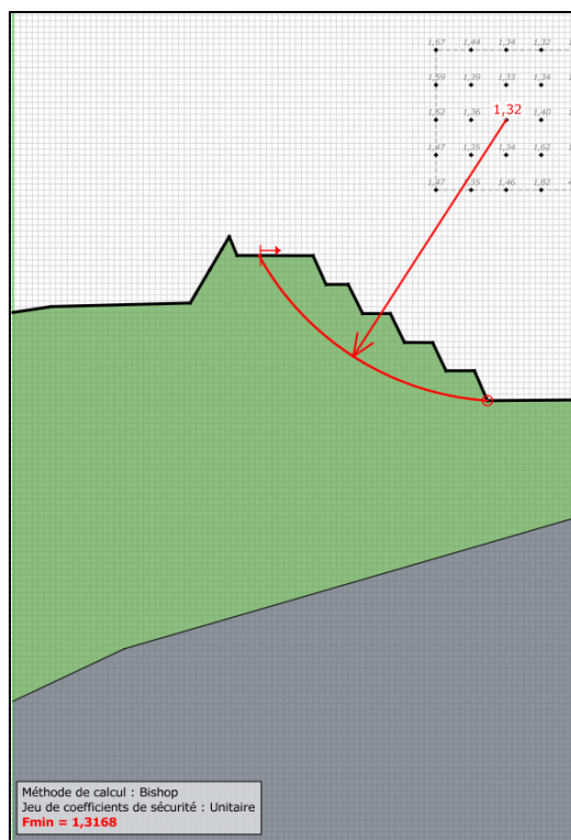
Figure N°188 : Stabilité du talus libre de la fosse « Philofele » suite à un séisme pesant de 0,08 g - Coupe 20 (FS=1,32)
