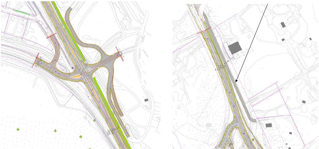
Figure 83. Vue en plan du carrefour en rive gauche et de la voie d’accès aux habitations en rive droite (source : PRO, Infratech, juillet 2024) En rive droite, le projet intègre le reprofilage de la piste existante parallèle à la RT1. Cet accès sera revêtu et permettra de maintenir la desserte des habitations mitoyennes au nouvel ouvrage. La réalisation du projet ne vise pas à augmenter le trafic mais à améliorer le passage de la Tontouta sur un ouvrage plus sécurisé. De même pour limiter les conflits d’usages, le parking en rive droite sera accessible uniquement depuis le nord avec un aménagement de signalisation horizontal : bande continue séparant la circulation. Le « tourne à gauche » sera donc interdite depuis le sud. En parallèle, l’ouvrage existant sera conservé. Il s’agit d’une volonté des communes de Boulouparis et de Païta pour transformer le pont existant en mode doux : piste cyclable et piétons.
