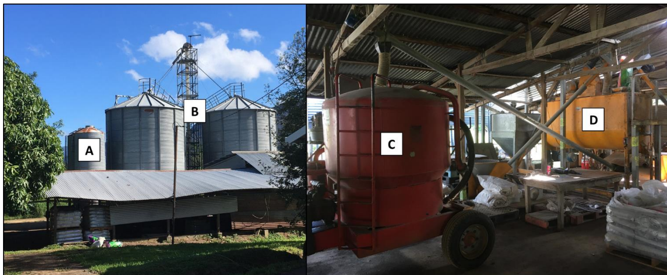
Figure 6 : Atelier à grain : A) Silos désaffectés ; B) Silos de capacité 60 tonnes ; C) Tracteur équipé d'une cuve ; D) Mélangeuse. À gauche extérieur du bâtiment et à droite intérieur du bâtiment
