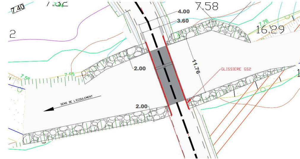
FIGURE 64. Localisation des enrochements de part et d'autre de l'ouvrage d'art (source : éTEC)
