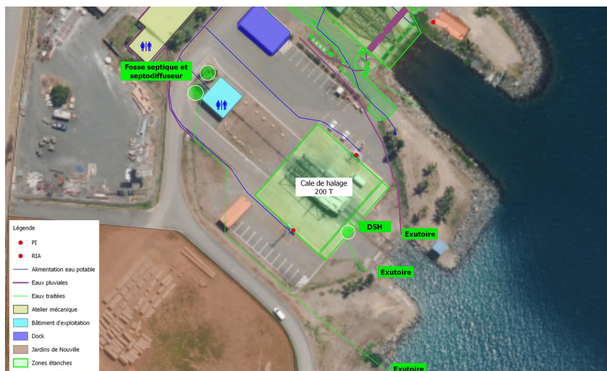
Figure 11 : Réseau de traitement des eaux de ruissellement des zones étanches (cale 200T)
