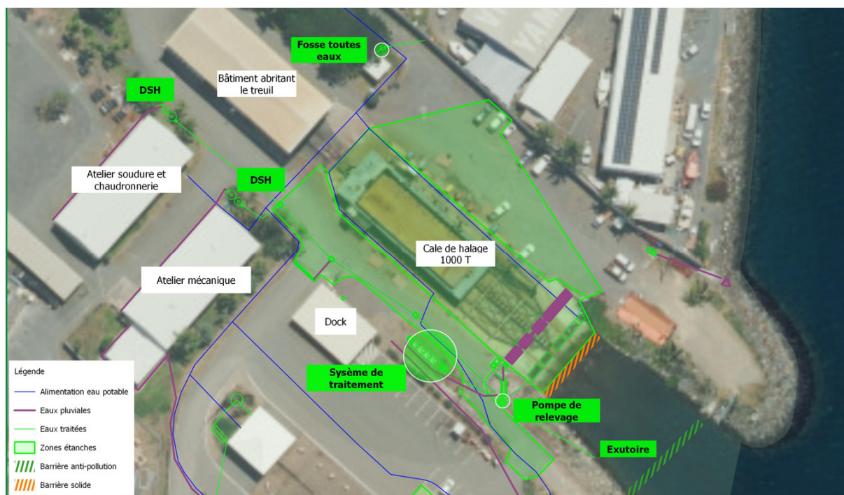
Figure 12 : Réseau de traitement des eaux de ruissellement des zones étanches (cale 1000T et ateliers)
