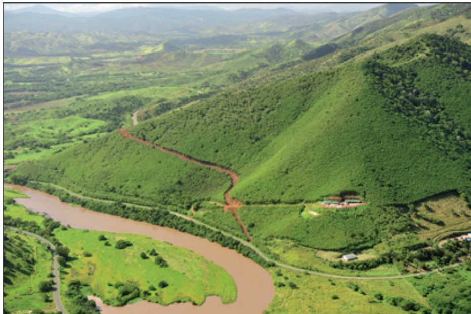
AMÉNAGEMENT NON ADAPTÉ DANS LA PENTE AVEC TERRASSEMENT DE TYPE DÉBLAIS / REMBLAIS
